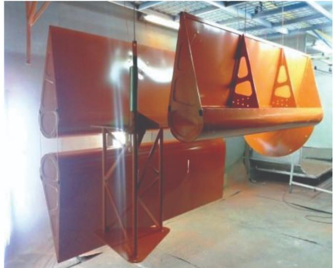
Figura 9: Pale e parti superiori del pilastro principale prima e dopo la procedura di verniciatura.
