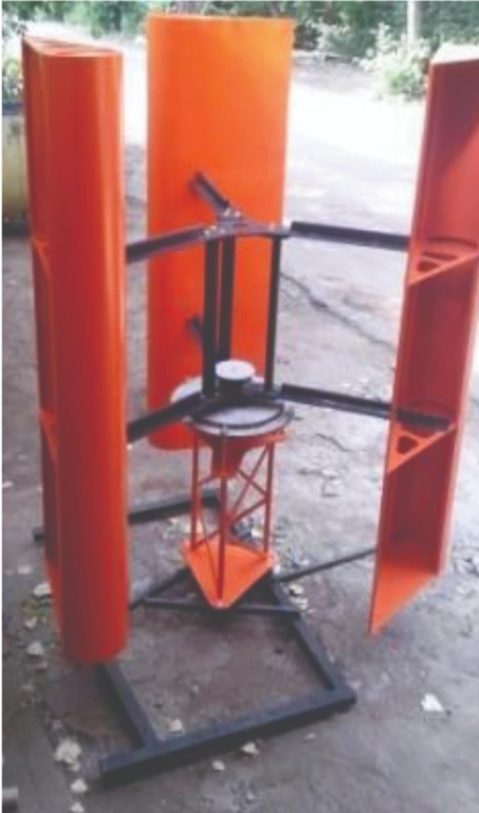
Figura 12: assemblaggio della turbina Lenz.
