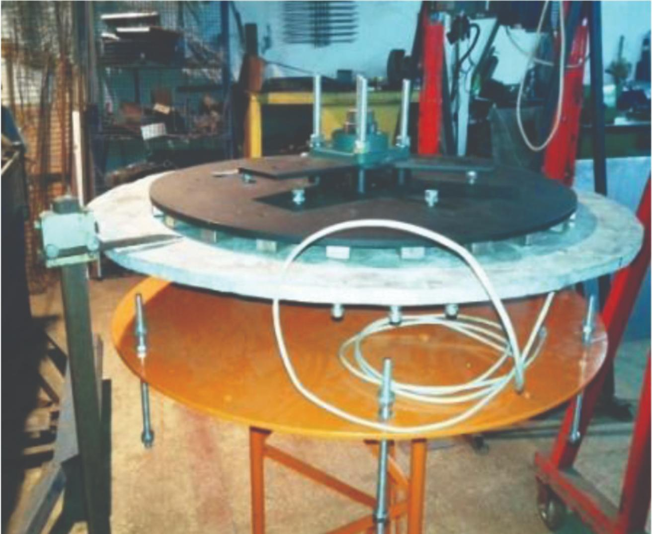
Figura 10: generatore assemblato.
