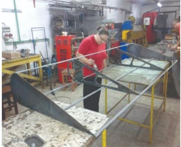
Figura 8: Torri della turbina (a sinistra) e pala (a destra) dopo l'applicazione dello strato protettivo di zinco.
