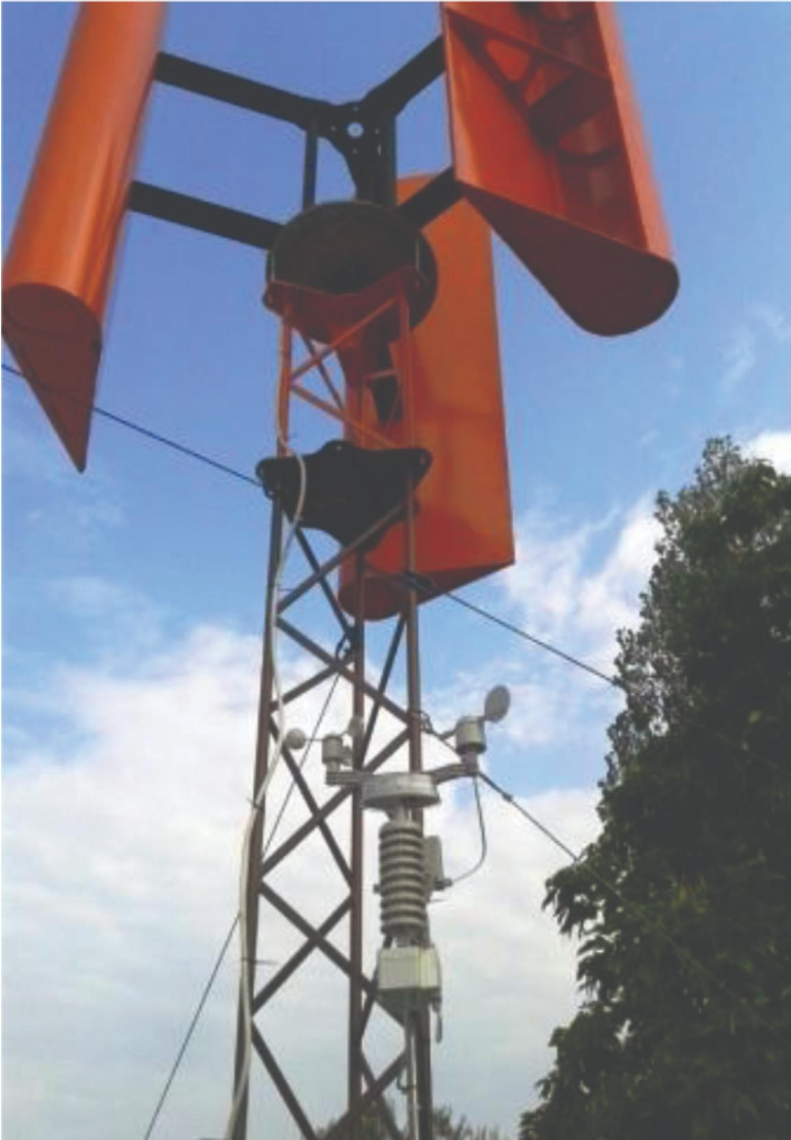
Figura 15: Turbina eolica Lenz: sguardo più da vicino.
