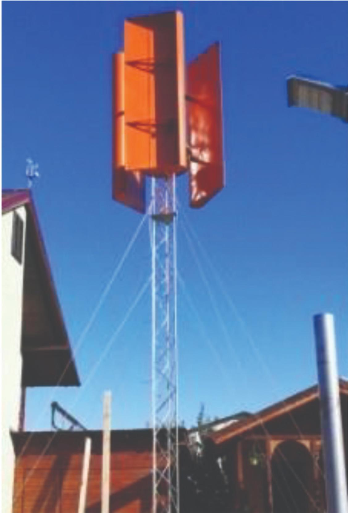
Figura 14: Turbina eolica Lenz installata.
