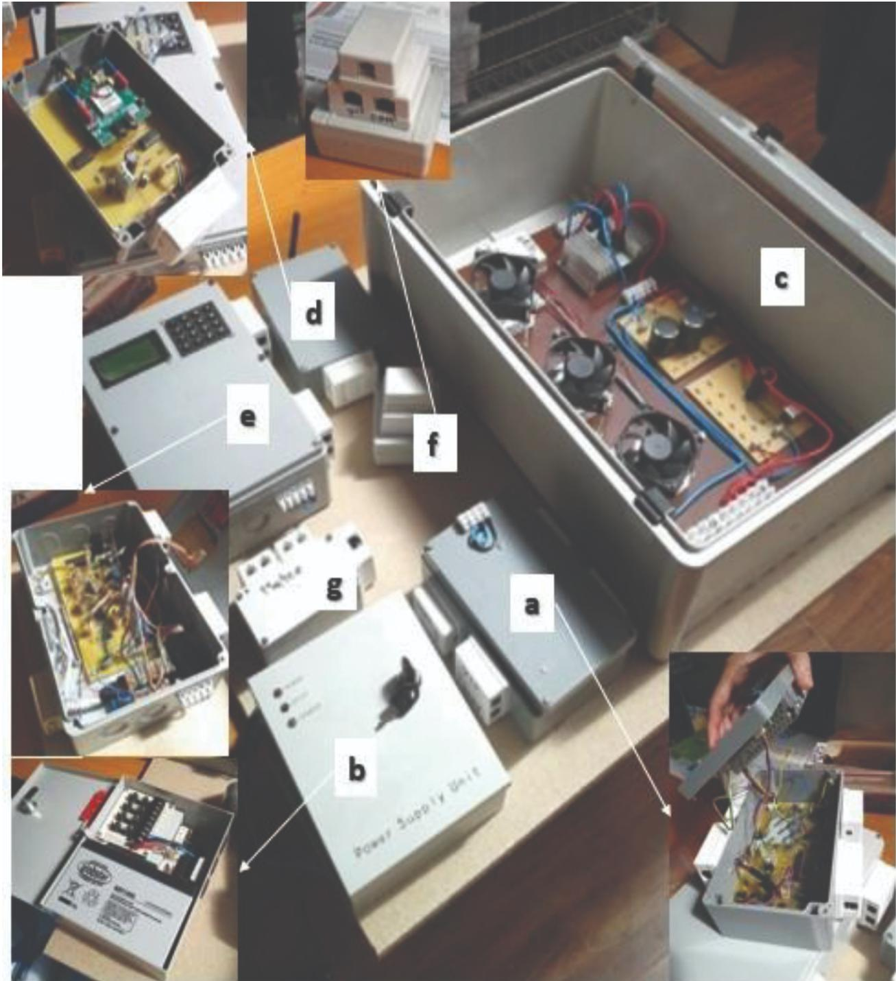
Figura 11: Elettronica della turbina eolica Lenz.
